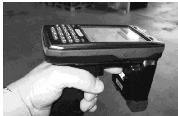
写真① RFID 読み取り専用ハンディ型ターミナル (HHT)
