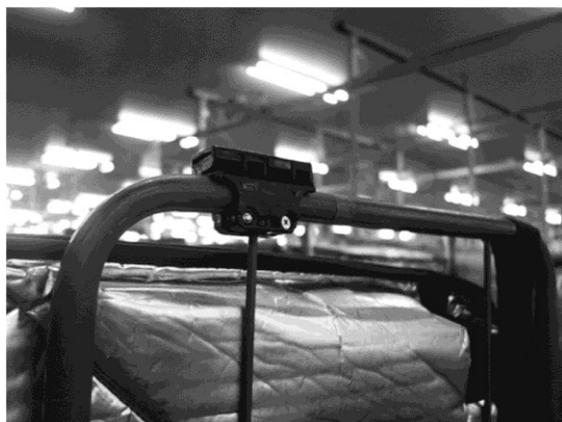
写真④ カゴ台車最上部に取り付けられたRFIDタグ
