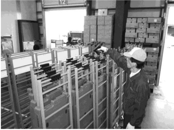
写真③ 台車の入庫時に HHT で RFID タグを読み取る様子
