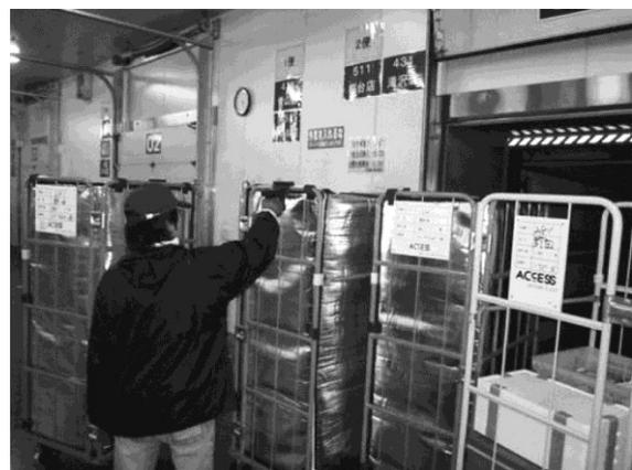
写真② 出荷時にHHTでRFIDタグを読み取る様子
